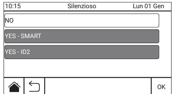
Lo SMART invia il comando "SILENCE VENTILATION" alle schede CPU collegate che forzeranno l'uscita YFx e quindi la velocità dei ventilatori ad un valore preimpostato.
