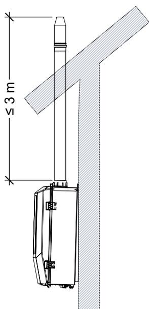
In caso di installazione di scarico fumi di lunghezza superiore a 3 m sarà necessario scaricare la condensa generata all'interno del camino prima dell'ingresso nella caldaia, inserendo un raccogli condensa all'innesto del camino oppure disassando lo stesso, portandolo all'esterno dell'ingombro della caldaia, e inserendo un elemento a "T", come mostrato negli esempi seguenti.
