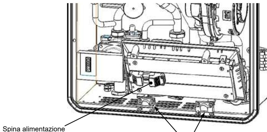
**Quadro elettrico montato con cerniere con frizione. Allentare la vite per muovere il quadro.**
