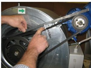
Appoggiare una barra rigida e perfettamente dritta sulle pulegge, applicare una leggera forza con un dito sulla parte centrale della cinghia e misurare la distanza tra il punto flesso della cinghia e la barra. La distanza deve essere compresa tra 1cm e 1,5 cm.
