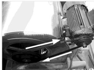
4. Nel caso il motore e il ventilatore dovessero ruotare in senso contrario, è necessario modificare il collegamento della linea al quadro elettrico esterno invertendo L1 ed L2.
